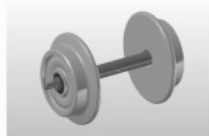
NZ 33288 Scheibenradsatz 10 mm schmal, AZ 13,2 mm zapfen- gelagert, einseitig isoliert
